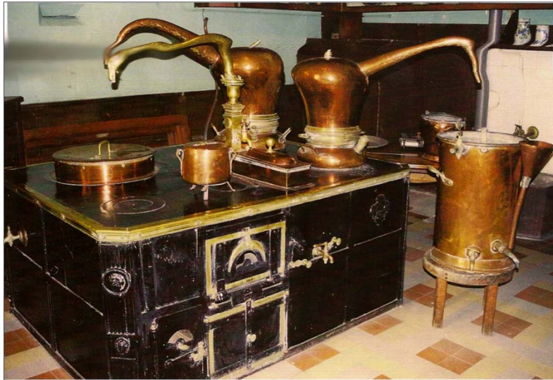
Fourneaux en fonte avec 2 alambics pour l'opération de distillation (XVI e - apothicairerie Hôtel-Dieu Bourg en Bresse)
