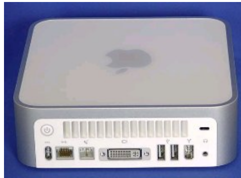
▲ IMG. 5 : FACE ARRIÈRE DU BÔTIER D'UN ORDINATEUR (MAC MINI) ; ICI, LE BOUTON DE DÉMARRAGE SE TROUVE EN HAUT À GAUCHE. - SPÉCIFIQUE
