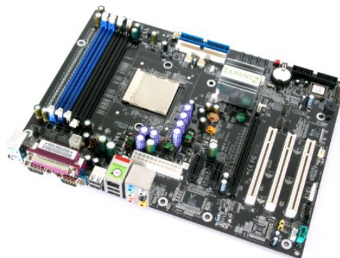
▲ IMG. 3 : CARTE MÈRE VIDE (PC) : EN HAUT À GAUCHE, LES EMPLACEMENTS DÉDIÉS AUX BARRETTES MÉMOIRE ; AU CENTRE, LE « CHIPSET », DESTINÉ À RECEVOIR UN MICROPROCESSEUR ; EN BAS À DROITE, ET AU PREMIER PLAN, DE NOMBREUX AUTRES « PORTS » (EMPLACEMENTS DESTINÉS À RECEVOIR DES PÉRIPHÉRIQUES INTERNES ET EXTERNES). - SPÉCIFIQUE
