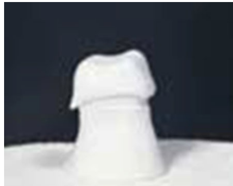
Figure 15 : Après la première étape (120°C) le plâtre s'est rétracté et détaché de l'infrastructure prothétique en cours d'élaboration
