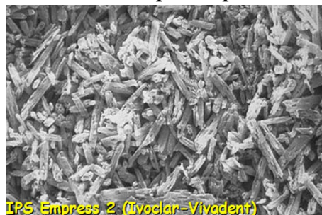
Figure 24 : microphotographie en microscopie électronique à balayage d'un échantillon de vitrocéramique Empress 2
