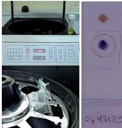
À gauche : cytocentrifugeuse. À droite : spot de cytocentrifugation sur lame après coloration.
