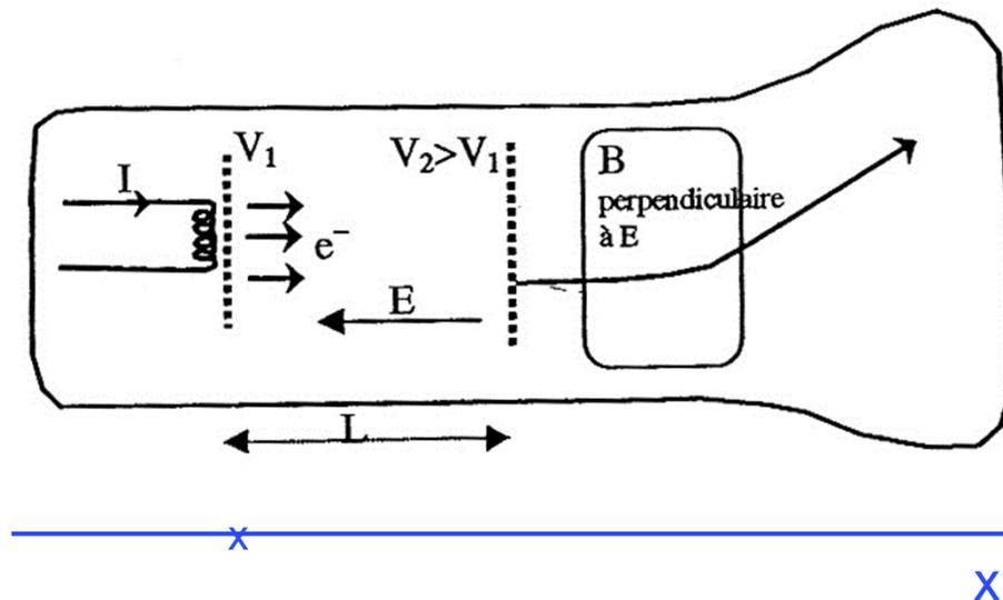
Les électrons sont extraits du filament par chauffage, accélérés par champ électrique uniforme suivant  $Ox$ , déviés par champ magnétique
